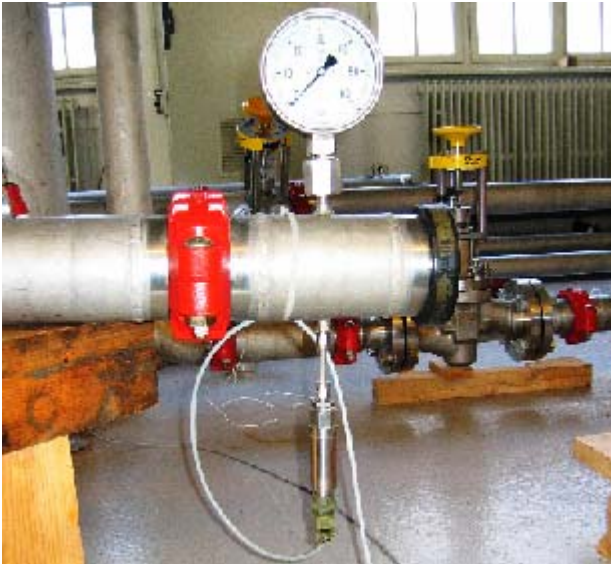
Abbildung 9 Beispiel eines eingebauten Drucksensors (oben mechanisch / unten Sensor)
